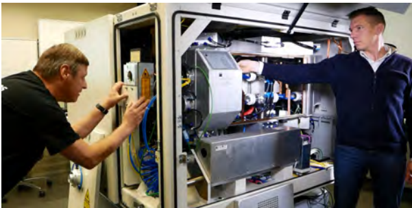
Abbildung 1: Videografie der Wartung „Auskoppelspiegel visuell prüfen“ (li.: Karl-Heinz Knapp, Serviceexperte Firma Trumpf GmbH + Co. KG, re.: Matthias Hedrich, Projektverantwortlicher Universität Stuttgart)
