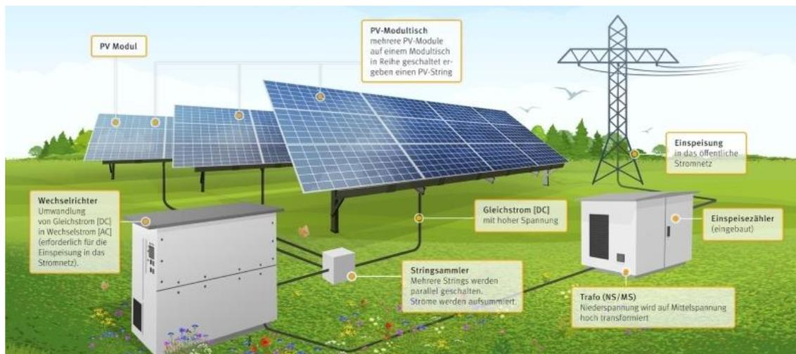
Abbildung 8: Funktionsschema einer Freiflächenphotovoltaikanlage<sup>13</sup>
