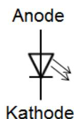
Abbildung 16: Schaltzeichen einer LED
