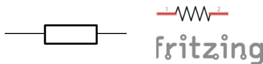
Abbildung 20: Schaltzeichen (Widerstand nach europäischer Norm sowie nach amerikanischer Norm in abgeänderter Form nach *fritzing*)
