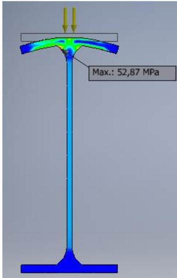
Die mit Zugdreiecken optimierte Form weist im Gegensatz zur Ingenieurkerbe mit einem einfachen Viertelkreis keine Spannungsspitzen mehr auf. Die Kräfte werden hier in das Bauteil abgeleitet. Die Kerbspannung sowie der Materialverbrauch können somit auf ein Minimum reduziert werden.
