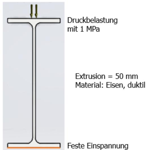
Abbildung 57: Doppel-T-Träger Analyse
