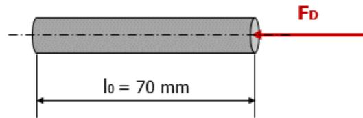
Abbildung 64: Spannungsberechnung Stab
