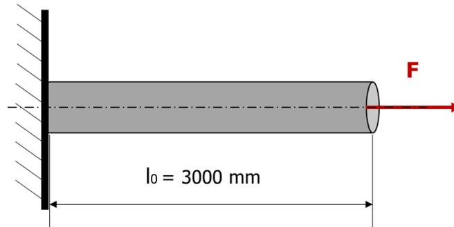
Abbildung 65: Dehnungsbestimmung Stahlstab
