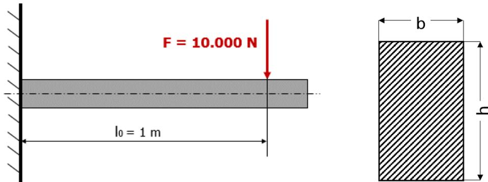
Abbildung 67: Beispiel Biegespannung
