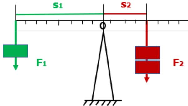
Abbildung 17: Aufbau Balkenwaage
