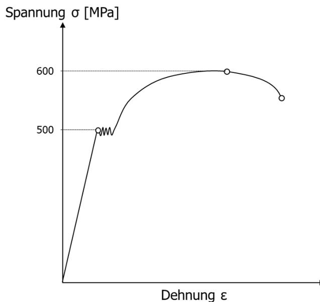
Abbildung 74: Spannungs-Dehnungs-Kurve von Betonstahl
