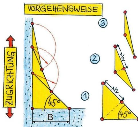
Abbildung 59: Zugdreiecksmethode (Bild: KIT)
