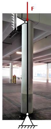
Abbildung 74: Druckbeanspruchung eines Balkens
